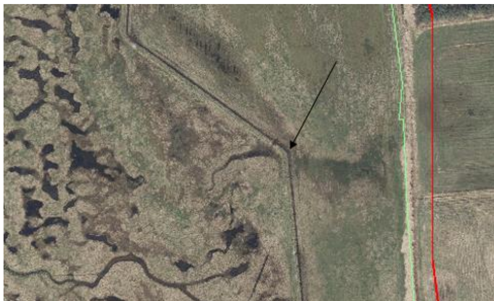
Figur 10-15 Volden/grøften langs det drænede areal i den sydlige del af delområdet virker som en barriere for tværgående hydrologiske strukturer (potentielle løsystemer).
