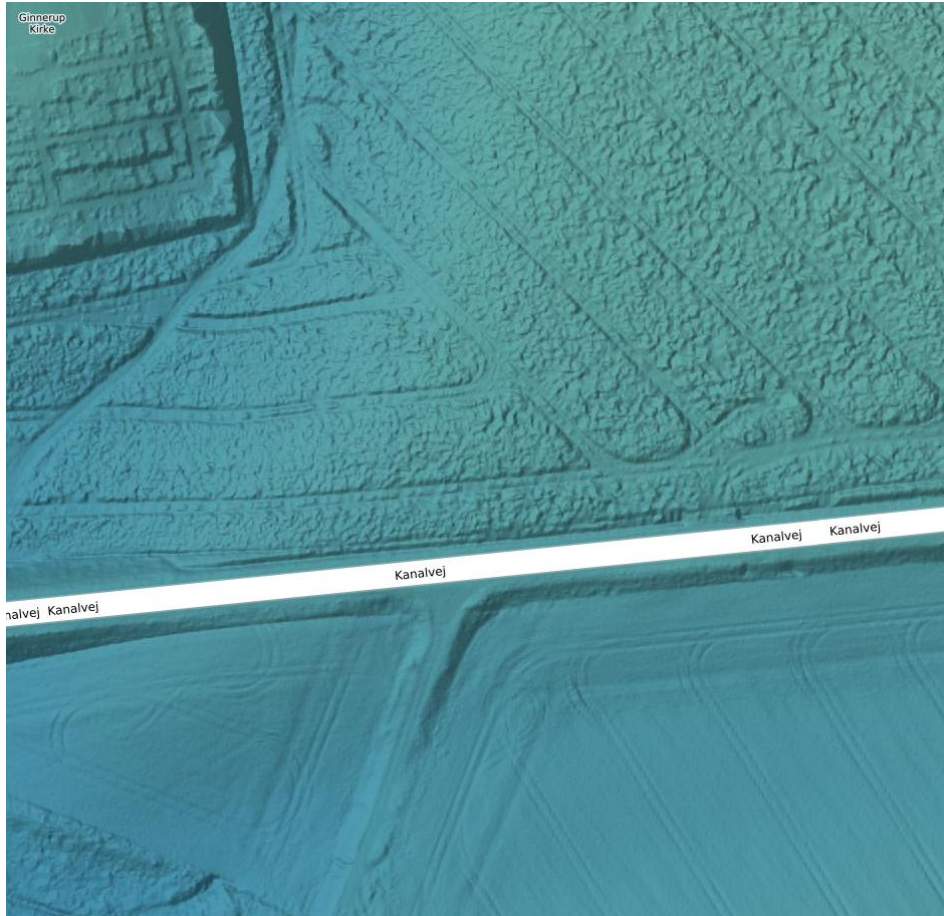
Figur 6, udsnit fra DHM2015 - opløsning grid str. 0,4 meter
