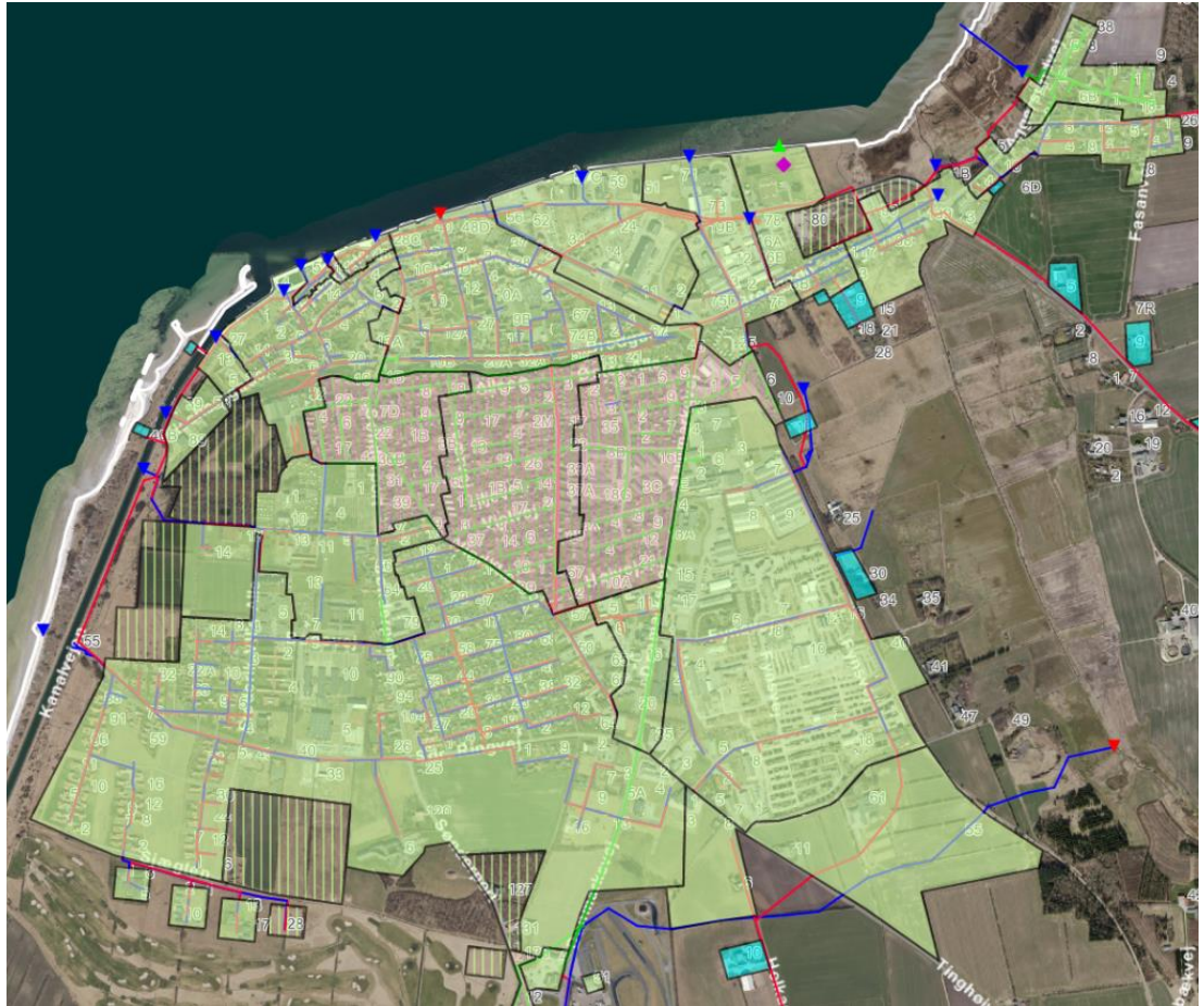
Figur 6-1. Eksisterende forhold, separatkloakeret område (lysegrøn), fælleskloakeret område (lyserød) og spildevandskloakeret (lyseblåt).
