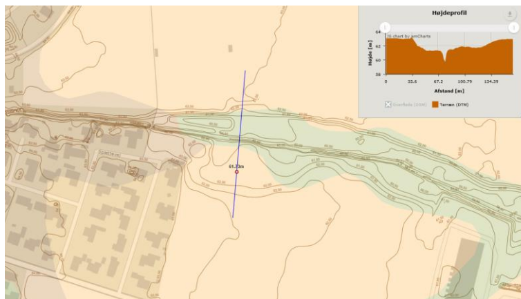
Figur 3: geologisk karteringskort med indlagt højdeprofil.
