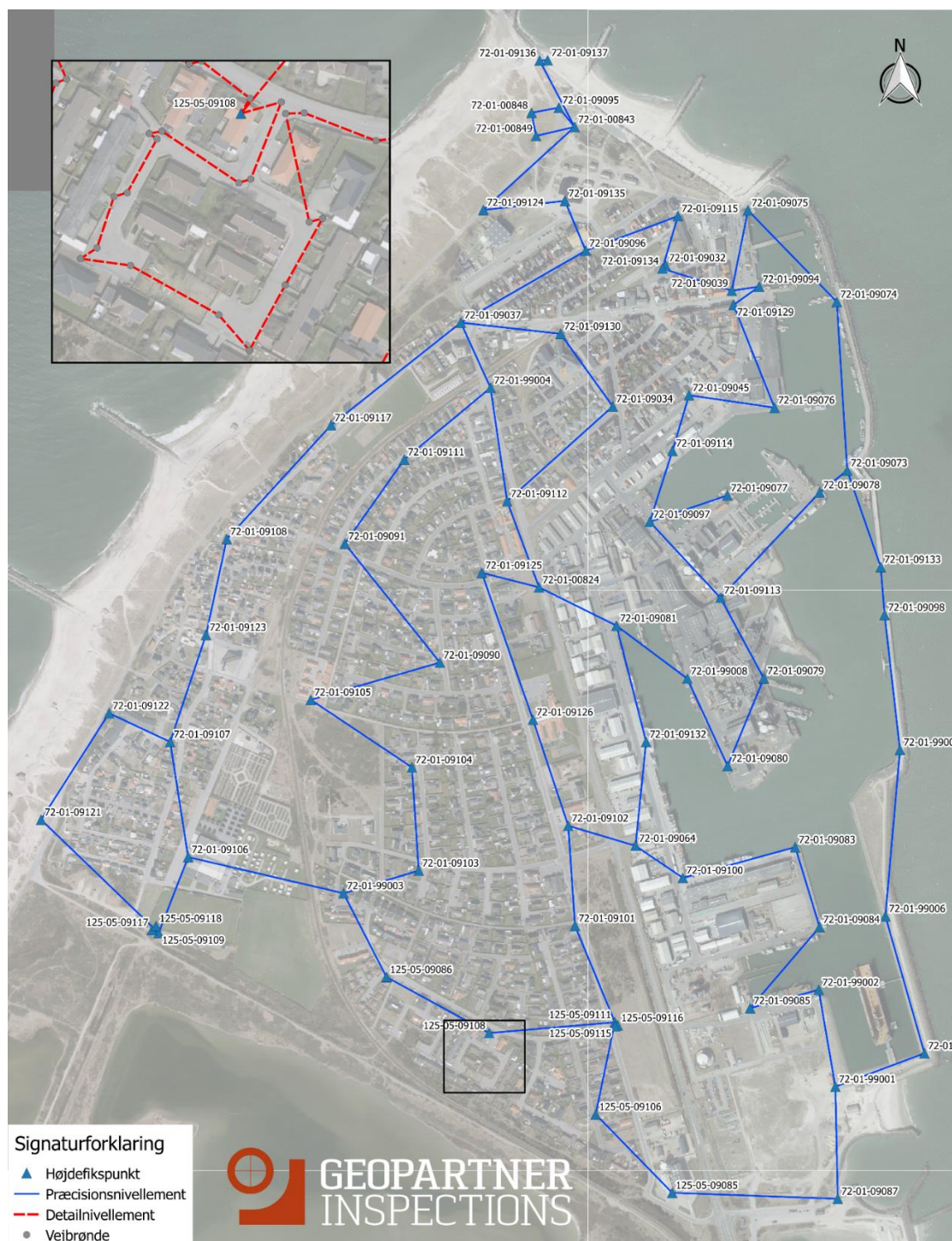
Figur 5.2. Fikspunktmålingen med eksempel på, hvordan brøndmålingen er hæftet på fikspunktnettet.
