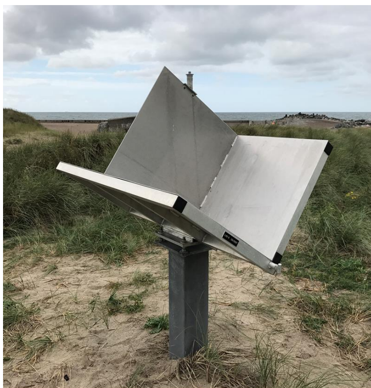
Figur 3.4. Radarreflektor LVS5 i Thyborøn.
