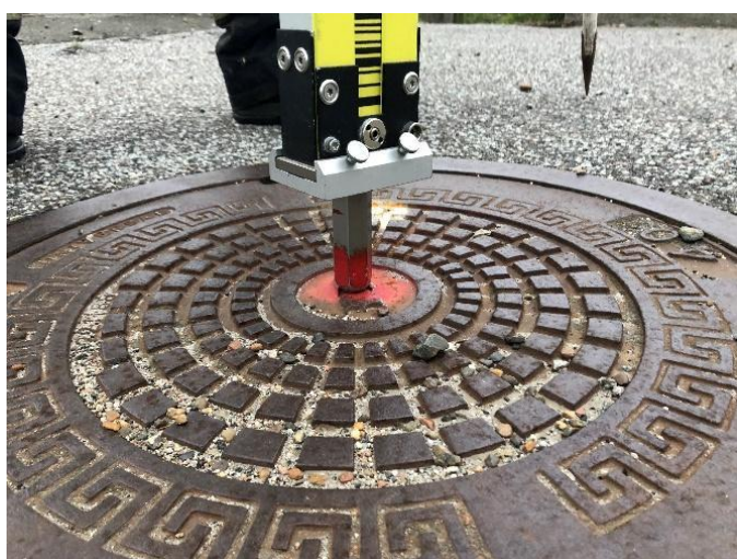
Figur 5.4. Stadie med adapter på midten af brønddækslet, som er defineret som "målepunktet" på alle dæksler.
