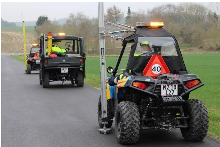
Figur 3.5. Det motoriserede geometriske nivellement bemanded med 1 tekniker og 2 målemedhjælpere. Holdet består af tre lette og miljøvenlige køretøjer monteret med præcisions-stadier, instrument Leica LS15 og PC.
