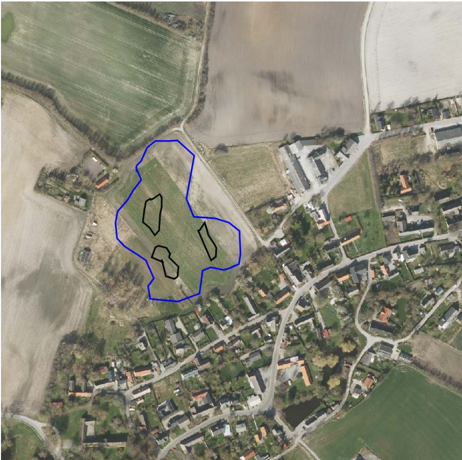
Figur 7.3: Udgravning ved Besser by med henblik på etablering af fri vandflade nær byen. Sorte markeringer er lave øer.
