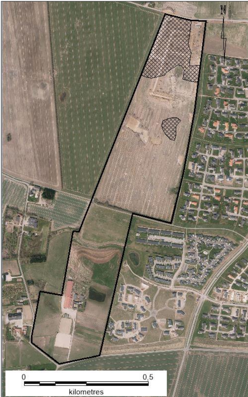
Figur 13: Oversigtskort over kortlægningsområdet ved Østerhåb Vest. De skraverede felter angiver de områder der, på baggrund af DualEM-421 screeningen, feltbeskrevet litografi og målte K-værdier anses for at være de mest egnede til fremtidige nedsvivningsløsninger.
